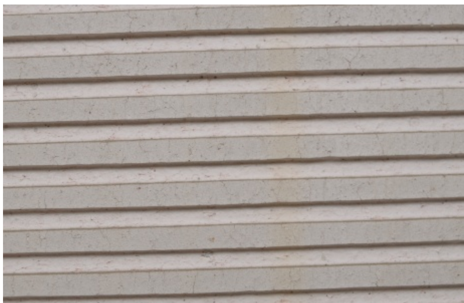
Omítací akumulční šamotové tvarovky AKUMOL
